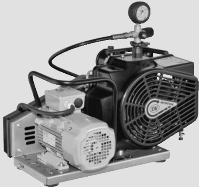
Die **LW 100 Serie** kombiniert alles was man von einem portablen Kompressor erwartet: Zuverlässigkeit, hohe Lieferkapazität und Mobilität. Das Kernstück des LW 100 ist sein hochmoderner 3-stufiger Kompressorblock bei dem sämtliche Zylinder und das Kurbelgehäuse als komplette Gusseinheit gefertigt werden.
